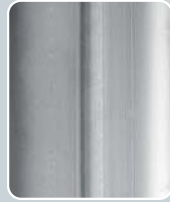
Schweißnaht gestrahlt weld seam bead blasted
